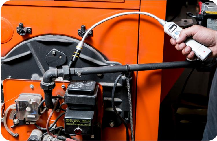
Das Lecksuchgerät ecom-LSG ist konzipiert für ein schnelles und sicheres Auffinden von Undichtigkeiten an Gasinstallationen. Im Unterschied zu Lecksuchsprays, die Abdichtungen aus z.B. Hanf aufquellen und so kurzzeitig wieder abdichten können, ist die Lecksuche mit dem ecom-LSG einfach und unproblematisch.
